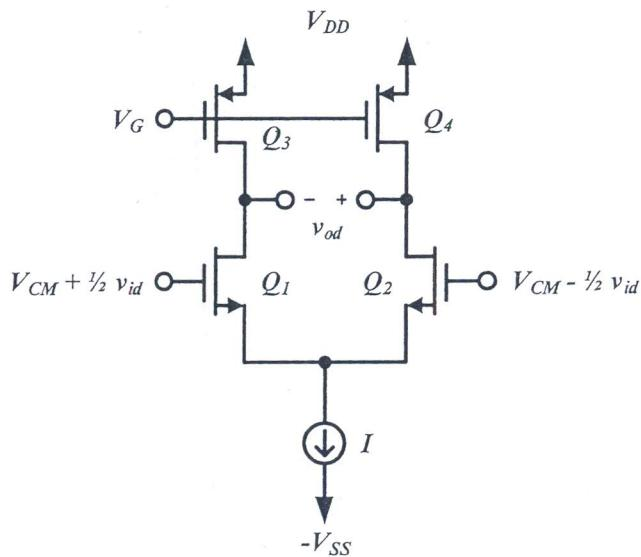
17. 差動放大器如下圖，假設電晶體皆工作在飽和區，忽略通道調變效應與基底效應。若欲提升差模小訊號增益  $|V_{od}/V_{id}|$ ，下列何者正確？(可複選，全對才給分)
