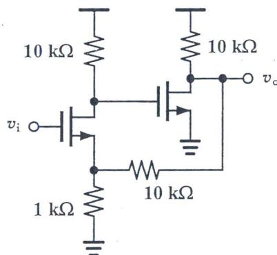
20. 如下圖所示之電路，假設電晶體皆工作在飽和區，忽略通道調變效應與基底效應，電晶體之轉導值  $g_m = 10 \text{ mA/V}$ 。請問該電路的輸出阻抗  $R_{out}$  為多少？（取小數點以下二位）
