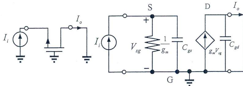
13. 在下圖電路中，所有電晶體均加以適當之偏壓  $V_{Bi}$ ，使每一電晶體都操作於飽和區同時均無基底效應，且轉導值皆為  $g_m = 1.6 \text{ mA/V}$ ，電晶體輸出阻抗皆為  $r_o = 5 \text{ K}\Omega$ 。求小訊號電壓增益  $v_o/v_i$  為多少？(正負號要對才給分)
